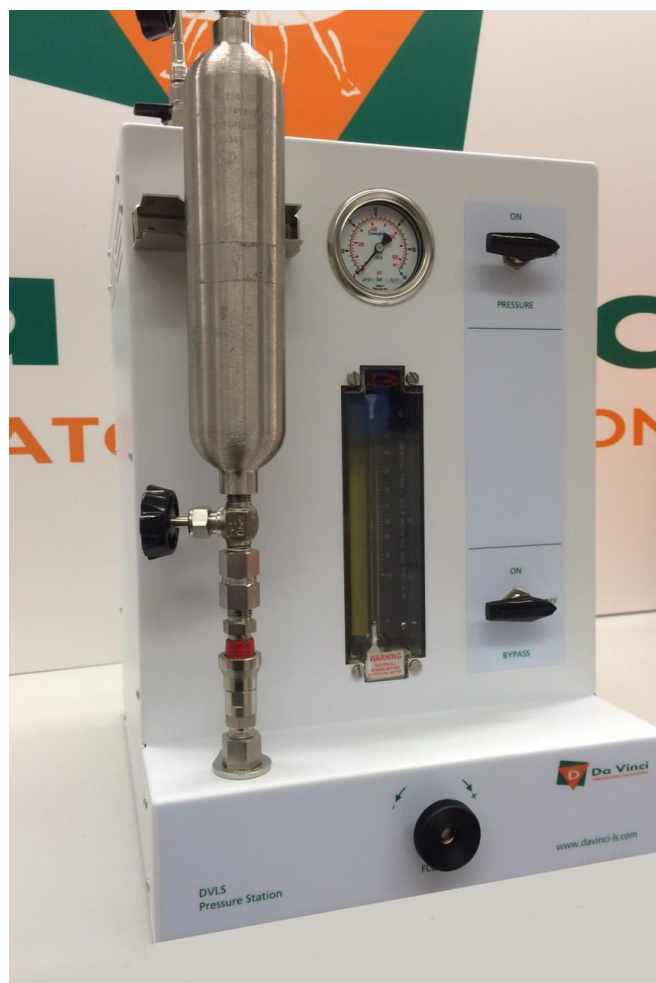
Estación de presurización configurada con vaporizador
